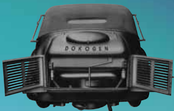
Škoda Superba, 1942 metų modelis su mediena kūrenamu generatoriumi DOKOGEN
